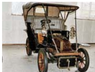
“De Dion Bouton Populaire” 1902 года стал одним из первых автомобилей с традиционным круглым рулем.
