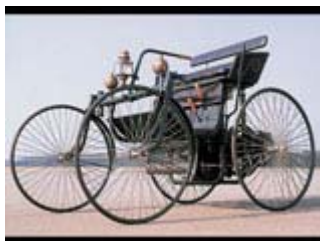
Длинный изогнутый рычаг управления на модели “Daimler Stahlradwagen” получил прозвище “бычий хвост”.
