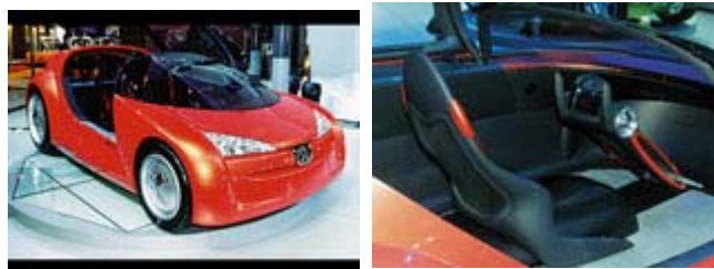
“Peugeot Bobslide” управляется двумя рычагами наподобие тяжелой гусеничной техники.
