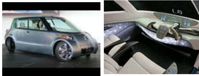
Вместо руля на “Toyota Fine-X” установлен “самолетный” штурвал.
