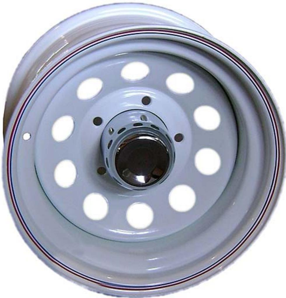
Штампованными дисками оснащаются большинство базовых версий автомобилей.
