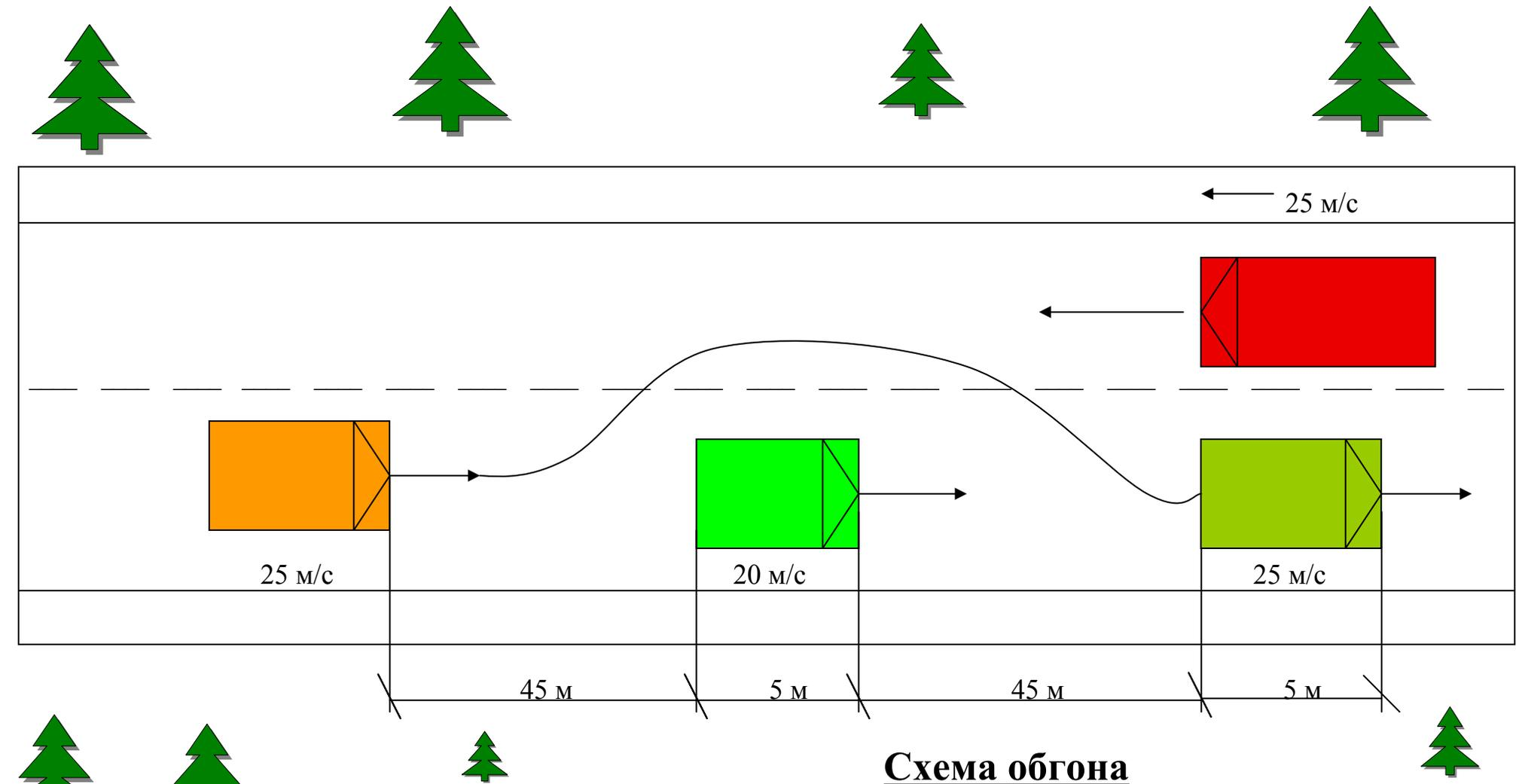
1. При  $\Delta V$  5 м/с для преодоления расстояния в 100 м необходимо время 20 с, но при реальной скорости 25 м/с за 20 с а/м пройдет 500 м, но чтобы избежать столкновения со встречным а/м, едущим с такой же скоростью, свободной полосы должно быть уже в 2-2,5 раза больше, т.к. главное условие при обгоне – это его безопасность. При различии взаимных скоростей обгоняющего и обгоняемого а/м будет разное время обгона и соответственно разное время нахождения обгоняющего а/м на встречной полосе.
